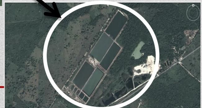
Las aguas negras o servidas son conducidas a un dispositivo de medición (canaleta parshall), dotado de una rejilla inclinada a  $45^\circ$  para la retención de sólidos gruesos, distribuyendo el caudal a las lagunas anaeróbicas (5 en total) por medio de un canal rectangular de concreto armado de  $1.70 \times 1.50$  m con una longitud de 70 m.
