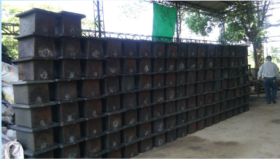
Cajillas para medidores de acueducto fabricadas con bolsas plásticas y vasija gruesa
